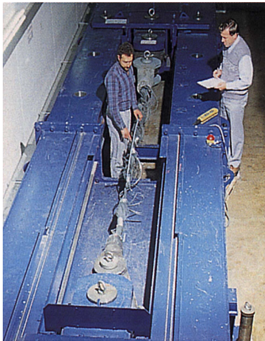
Zerreiversuch an Brcken-Drahtseil 6000 kN (600 to) 1987
